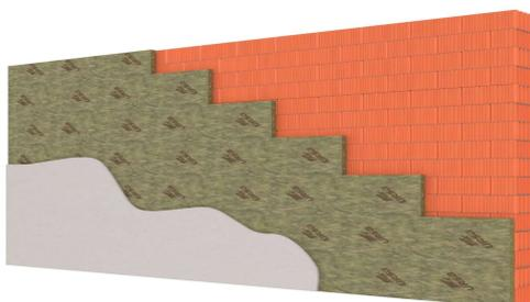
Beispielhafte Anwendung der URSA TECTONIC Vorsatzschalendämmplatte: Klebmontage auf Ziegelmauerwerk, mit armiertem Gipsputz beschichtet
