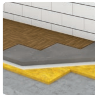
Trittschalldämmung unter schwimmendem Estrich
